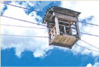
[野猿] 猿が綱渡をしているように見えることから名前がついた人力ロープウェイ。
