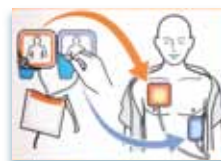
パッドに合わせて色分けされた パッド装着指示ランプ
